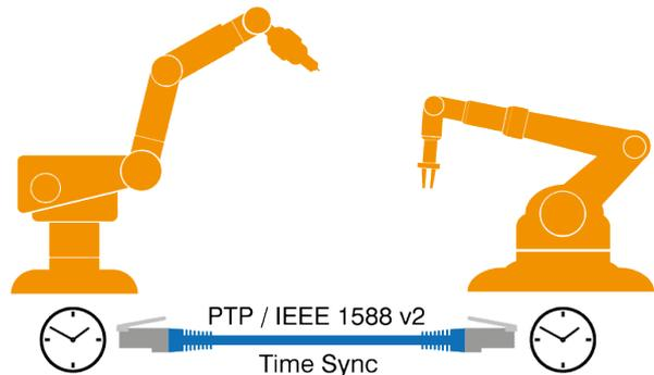
Das Precision Time Protocol kann mit oder ohne Hardwareunterstützung verwendet werden. Das Protokoll selbst ist schon als reine Softwarelösung in der Lage, Timer mit einer Präzision von weniger als einer Millisekunde zu synchronisieren. PTP Hardwareunterstützung für das Netzwerkinterface kann die Genauigkeit auf ca. 100ns zwischen Slave (Ordinary Clock) und Referenz (Grandmaster Clock) steigern.
