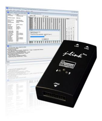
Typischerweise wird der Mikroprozessor des Zielsystems im Reset gehalten, so dass der J-Link Zugriff auf den Flash hat. Er kann dann alle üblichen SPI-Flashes verschiedenster Hersteller auslesen, verifizieren, programmieren oder löschen.
